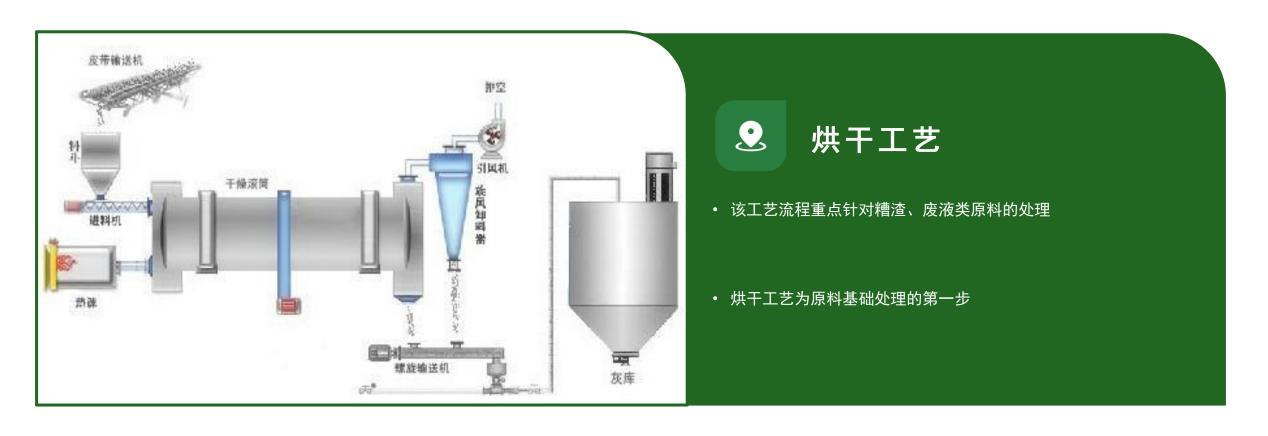
主要用于糟渣、废液类的处理。可采用燃烧生物颗粒燃料、蒸汽、天然气三种方式来进行烘干处理。
